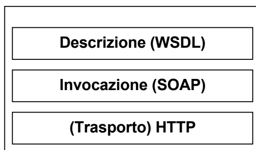
Figura 2.4 - Stack di base che garantisce l'interoperabilità dei Web Services
